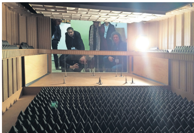
Alle effecten van ontwerp wijzigingen worden getest in een 1:10 schaalmodel.
